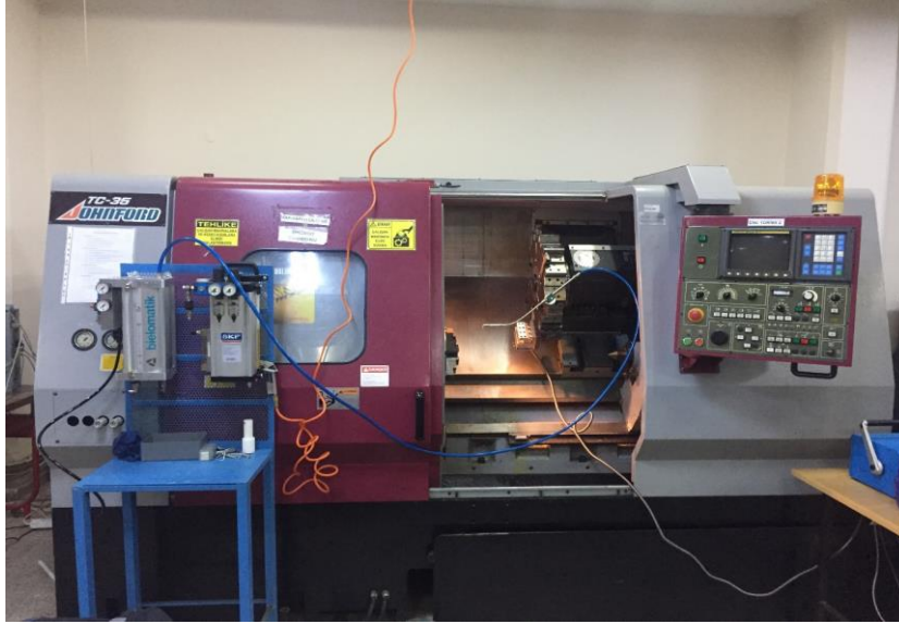
Şekil 1: JohnFord TC35 CNC torna tezgahı ve deney düzeneği
